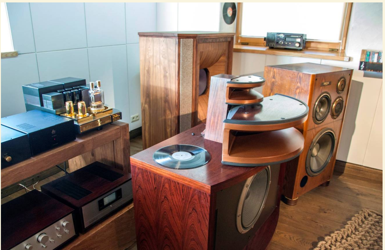
Трехполосная АС «Technics SB-10000» с секториальными рупорами средних и высоких частот.
