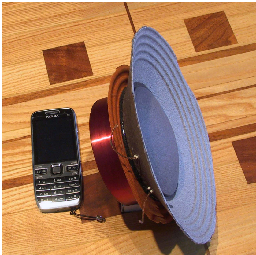
14 pav. „TAD“ 16“ ŽD draiverio membranos išpjova.
