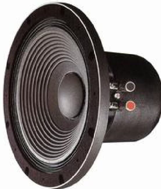
12 pav. Profesionalios paskirties 11" žemųjų dažnių draiveris „TAD“ TL-1102. Pagrindinės konstrukcijos ypatybės: popieriaus masės kompozicinė membrana su stangrumą didinančiais žiedais, 65 mm diametro ritė, suvyniota stačiakampiu laidu, Alnico magnetinė sistema su ritės aušinimo sistema, didelės eigos „akordeono“ tipo stangri pakaba, lietas garsiakalbio korpusas.
