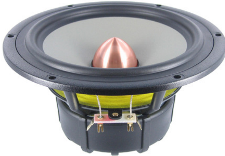
10 pav. „Seas“ Excel W18E-001. Siekiant geresnio ŽD atkūrimo, nedidelio garsiakalbio membranos paslankumas turi būti labai didelis, tačiau tai mažina jautrį ir maksimalų AS galingumą.
