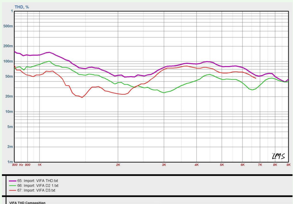
9 pav. VIFA PL27TG35 iškraipymai: THD - violetinė spalva, antroji harmonika D2 - žalia, trečioji D3 - raudona
