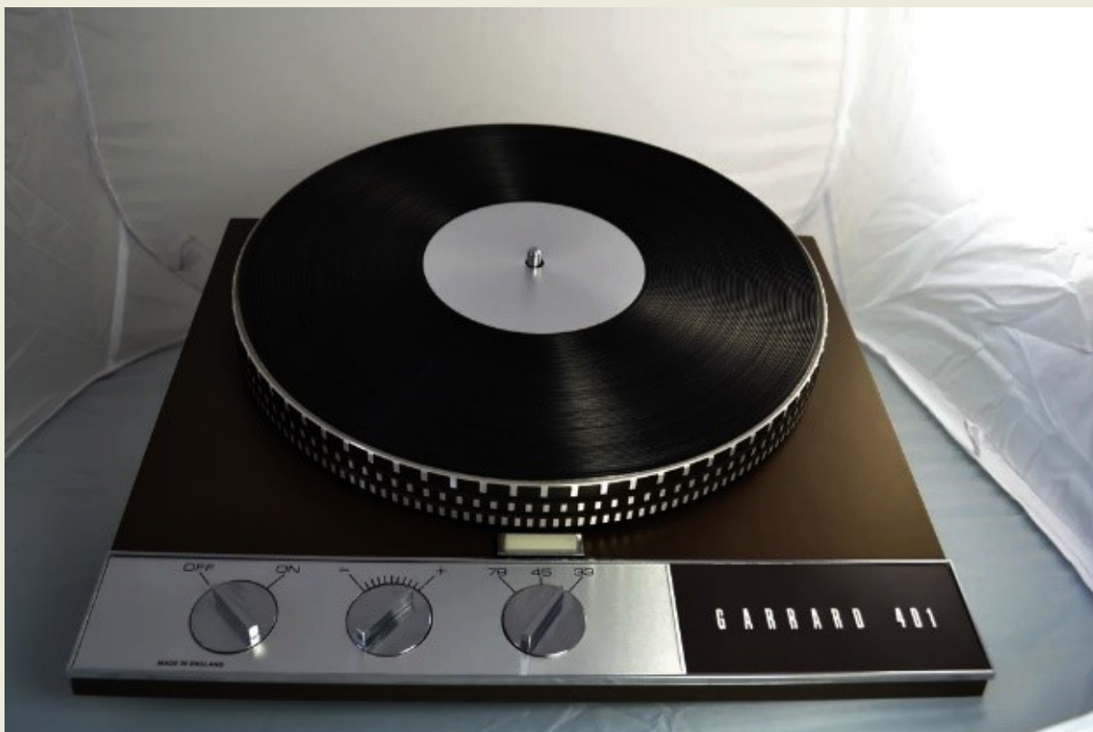
5 pav. Ratukinis Garrard 401 plokštelių suktukas
